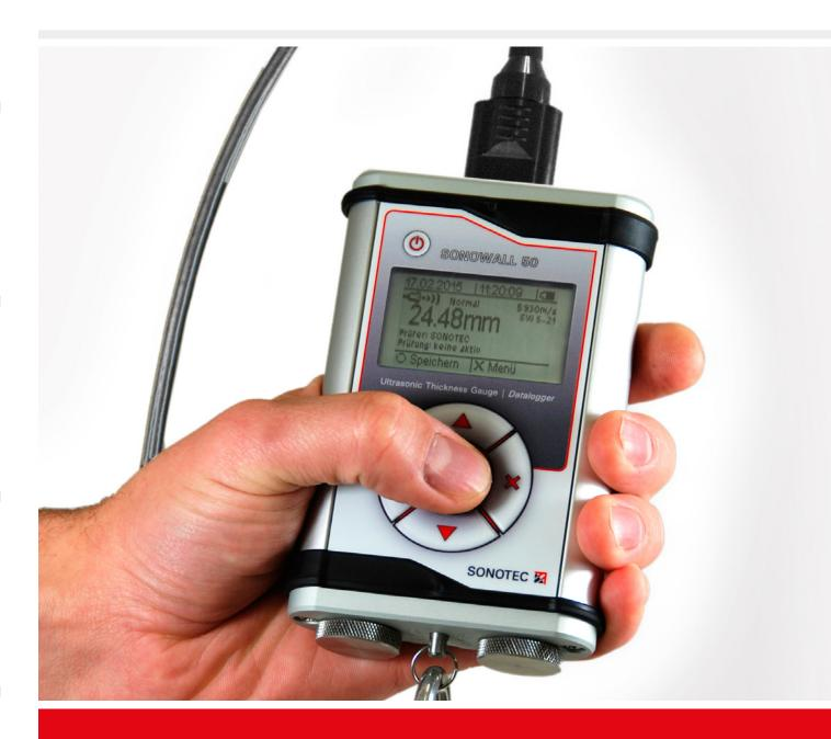
ULTRASONIC WALL THICKNESS GAUGE
